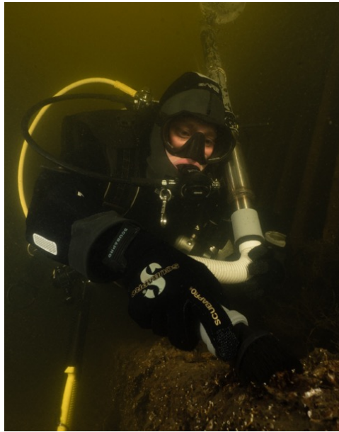
Foto 2.4 Air lift in gebruik door een duiker (links) en boven water (rechts). Foto links: © Peter van Rodijnen, rechts: principetekening van de air-lift (Bureau Waardenburg).
