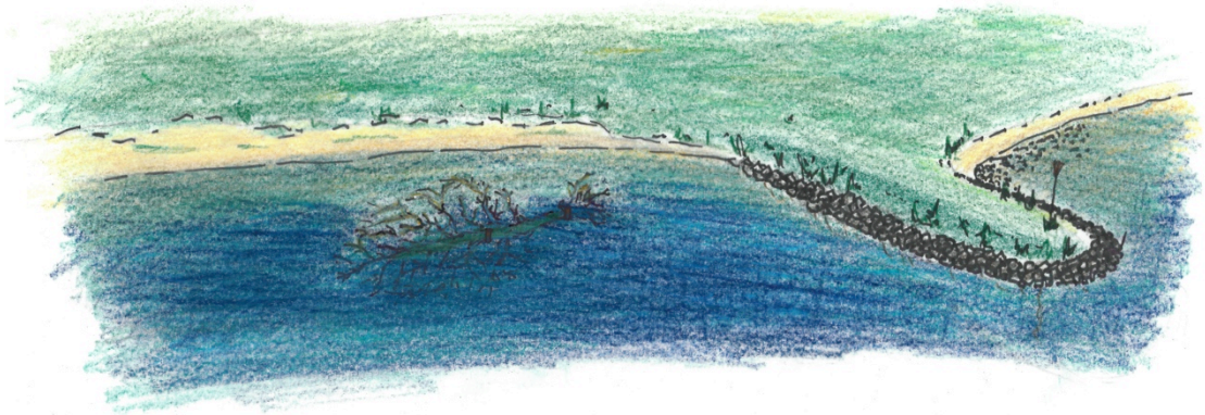
Figuur 1.1 Principeschets dood hout nabij de krib. De boom ligt in de stroomschaduw van de krib (stroming komt van rechts) in de figuur.
